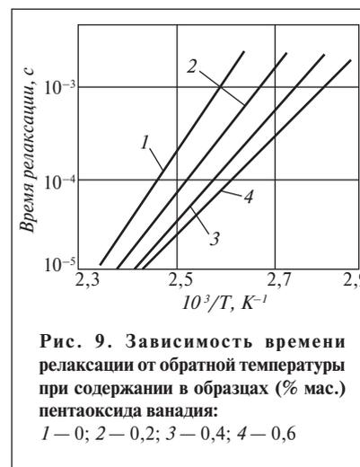
**Рис. 9.** Зависимость времени релаксации от обратной температуры при содержании в образцах (% мас.) пентаоксида ванадия:
