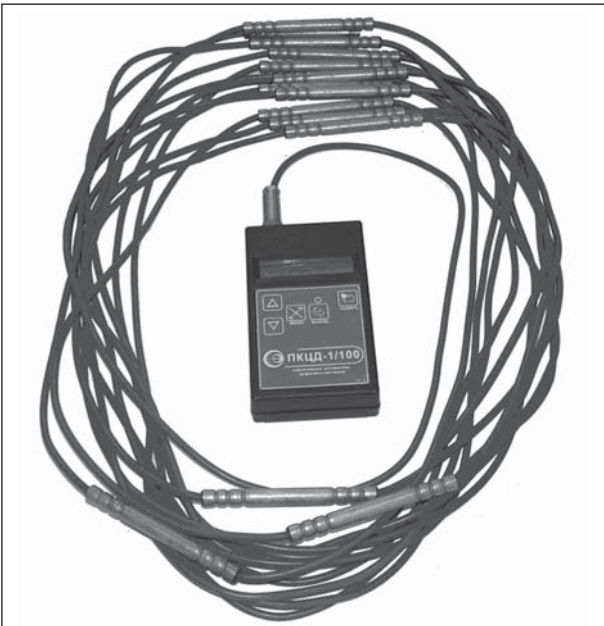
Рис. 1. Термокоса МЦДТ 0922 с контроллером ПКЦД-1/100
