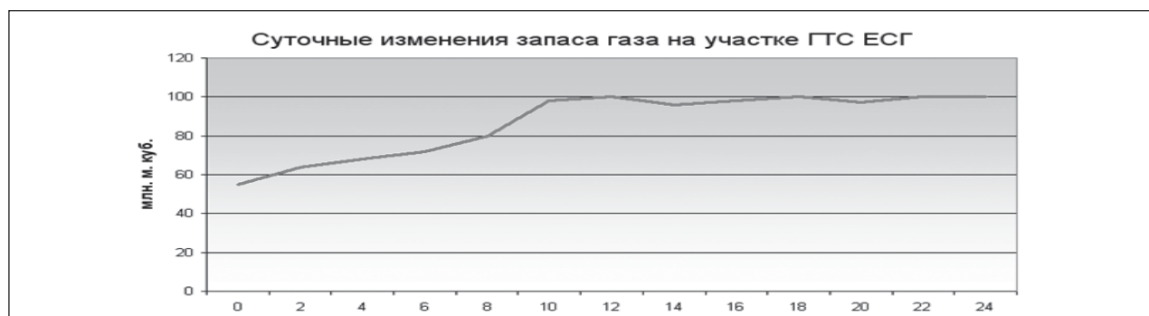
Рис. 4. Суточные изменения запасов газа внутри газопровода
