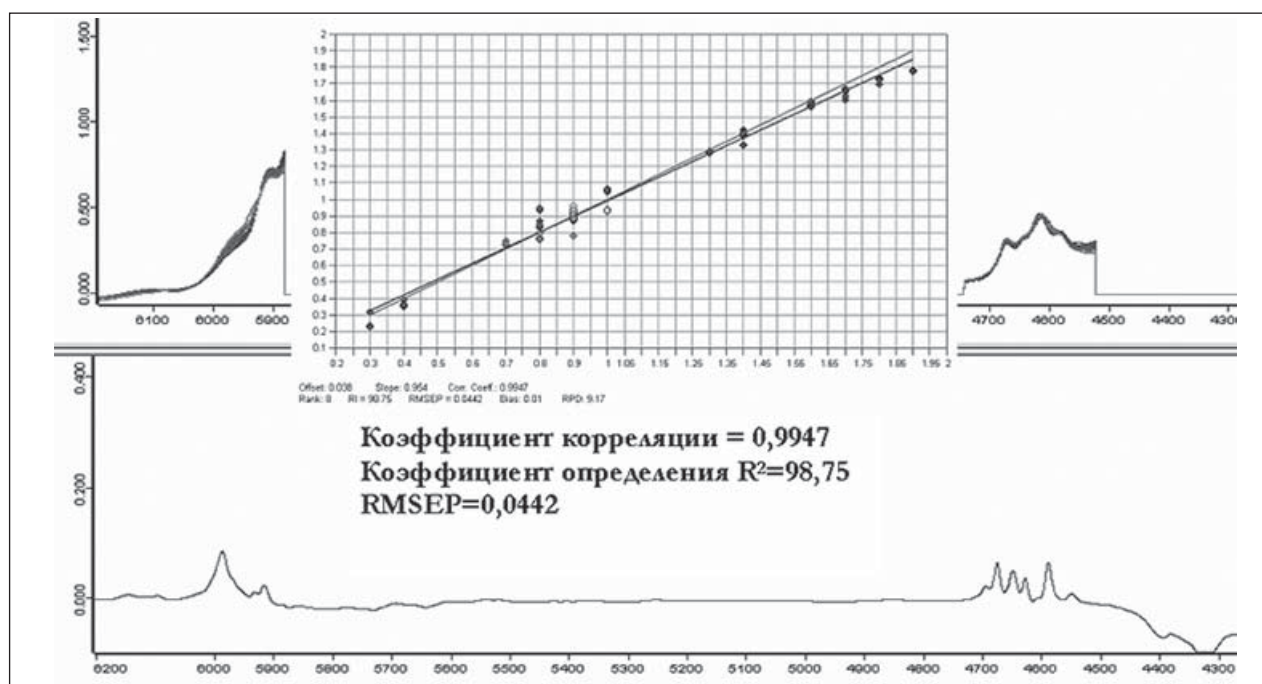
Рис. 3. Хемометрическая модель прогнозирования содержания бензола в бензинах: вверху — серия предварительно обработанных спектров с известными концентрациями бензола и график прогнозируемых значений концентрации против соответствующих приготовленным; внизу — спектр поглощения бензола в ближнем ИК-диапазоне, полученный вычитанием из спектра его раствора в бензине полос поглощения бензина
