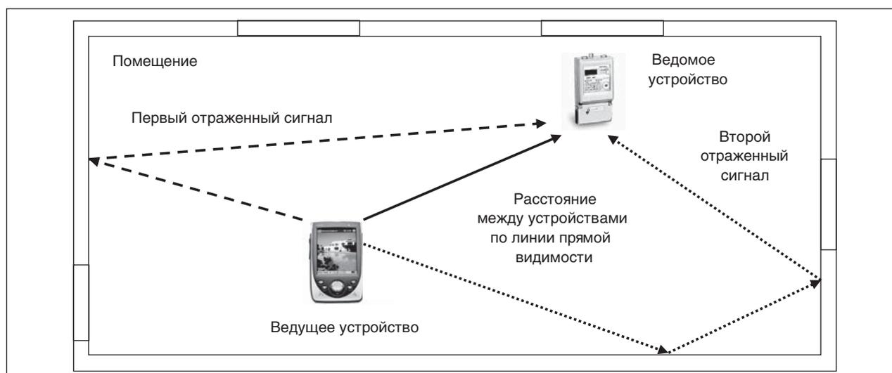
Рис. 2. Модель распространения радиоволн при размещении ведущего устройства внутри помещения
