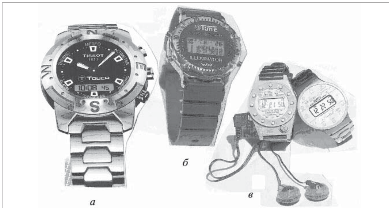
Рис. 1. Электронно-механические часы с кварцевым осциллятором: а — кварцевые часы с цифровой и стрелочной индикацией; б — кварцевые часы с цифровой индикацией; в — кварцевые часы с цифровой индикацией и FM-радио
