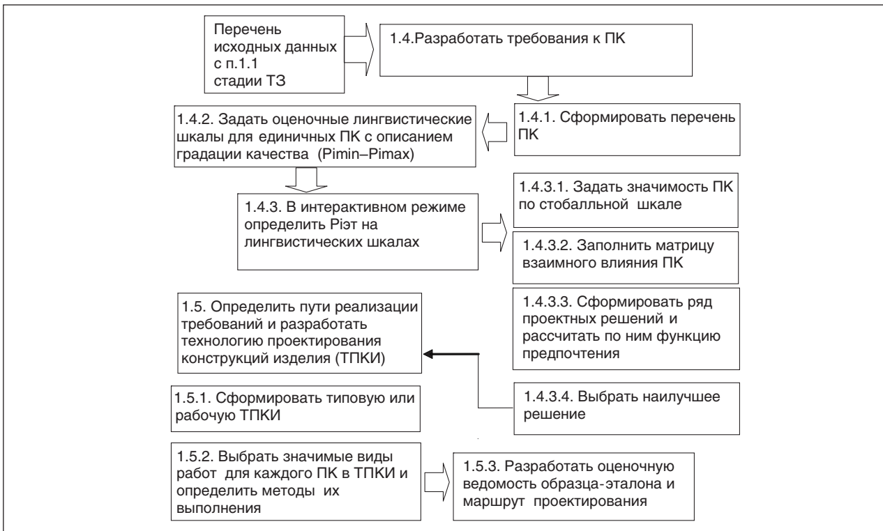
Рис. 2. Последовательность выполнения действий при разработке требований к показателям качества изделия на стадии ТЗ
