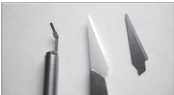
Рис. 8. Хирургический режущий инструмент из монокристаллов ЧСЦ
