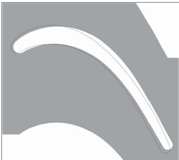
Рис. 3. Геометрия исходного профиля (серый фон) и оптимизированного (черная линия)
