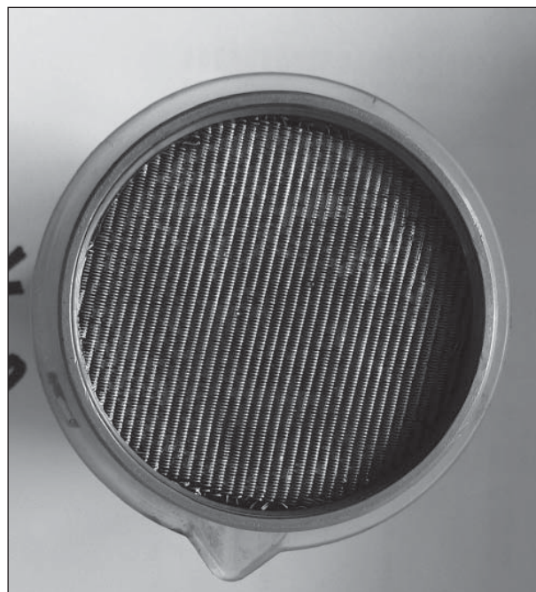
Рис. 3. Взаимодействие 15%-ной ингибированной HCl с добавкой 4% об. Нефтенола К с нефтью месторождения не дает осадков АСПО
