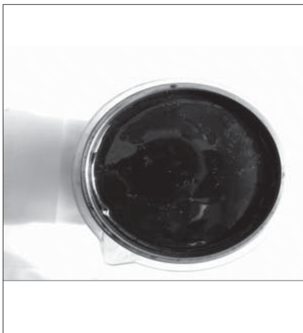
Рис. 2. Осадок АСПО после взаимодействия 15%-ной ингибированной HCl (без ПАВ) с нефтью
