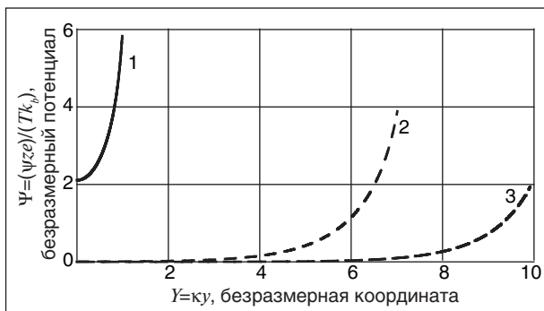
Рис. 3. Профиль распределения потенциала при разных дзета-потенциалах: 1, 2, 3 — распределения для соответствующих ζ-потенциалов 50, 100 и 150 мВ
