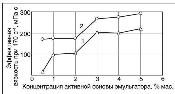
Рис. 4. Эффективная вязкость обратных эмульсий в зависимости от концентрации композиционного эмульгатора на основе рапсового масла: 1 — 80°C; 2 — 20°C
