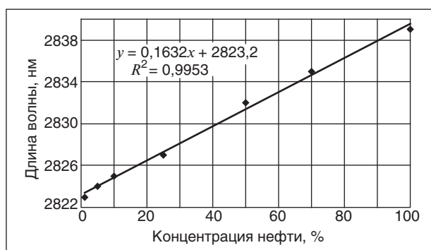
Рис. 5. Калибровочная кривая зависимости длины волны от содержания нефти в ГК
