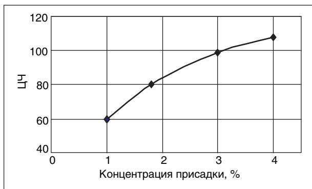
Зависимость цетанового числа (ЦЧ) от концентрации присадки (этилнитрата)
